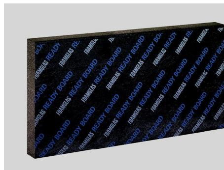
FOAMGLAS® READY BOARD T4+ состоит из склеенных между собой блоков FOAMGLAS®. Верхняя поверхность покрыта битумом, что позволяет наплавлять гидроизоляцию при помощи газовой горелки. Нижняя поверхность покрыта стекловолокнистым холстом белого цвета.
